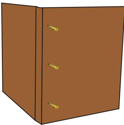
Assemblage de l'arrière et d'un côté avec 3 clous.
