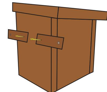
Poser des deux modules d'attaches de façon parallèle. 1 clou pour chaque module.
