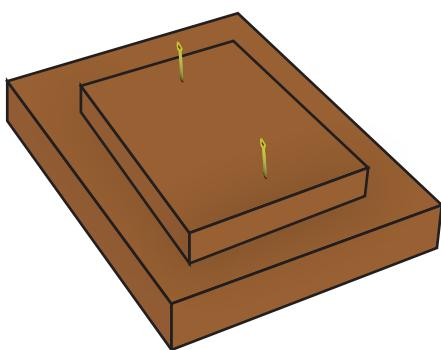
Fixation du deuxième fond avec 2 clous sur le toit. Afin de l'emboiter sur le nichoir
